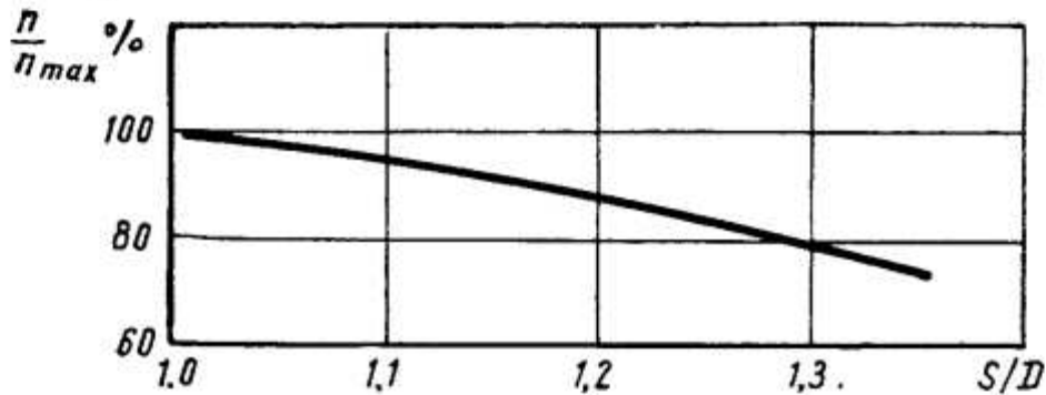
Фиг. 68. Характер зависимости отношения чисел циклов СПГГ
